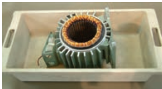
شکل ۲۱-۴ قرار دادن استاتور در درون وان شارلاک
