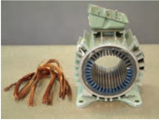
شکل ۲-۲۴- سیم‌های بیرون آمده از استاتور
