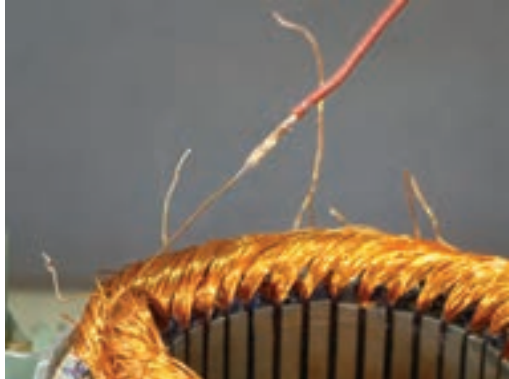
شکل ۴-۱۱- اتصال سیم‌های افشان به سیم‌های لاک‌ی
