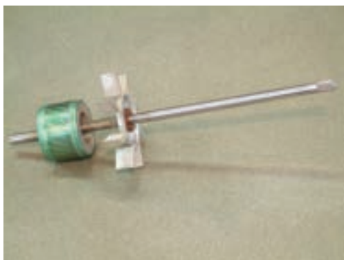
شکل ۲۸-۱- پروانه‌ی نصب شده روی محور روتور
