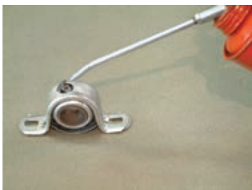
شکل ۱-۳۴- روغن کاری یاتاقان ها
