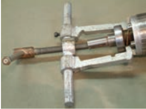
شکل ۱-۴۶- استقرار بلبرینگ کش روی محور روتور
