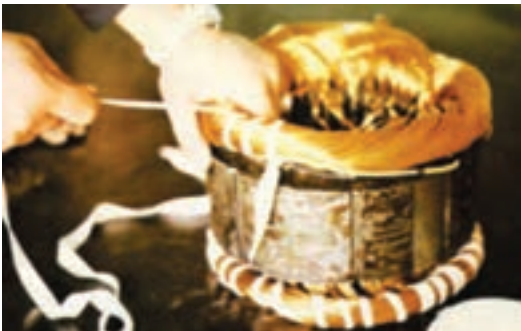
شکل ۴-۱۸– نواربندی سیم‌های استاتور
