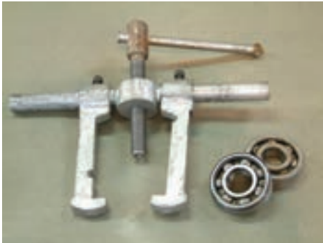
شکل ۱-۴۷- بلبرینگ‌ها پس از جدا شدن از محور
