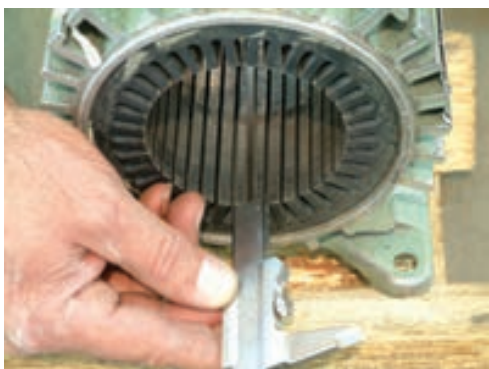
شکل ۲-۳۲- اندازه گیری طول شیار
