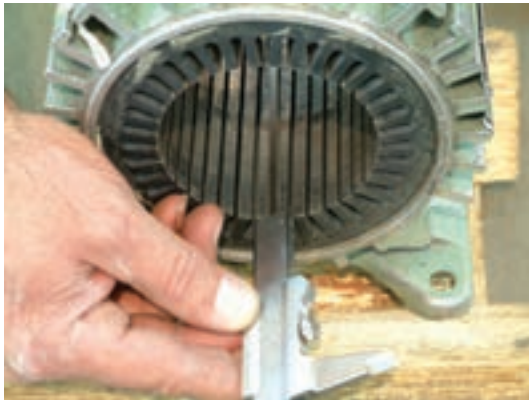
شکل ۲۶-۲- اندازه گیری محیط داخلی و طول شیار
