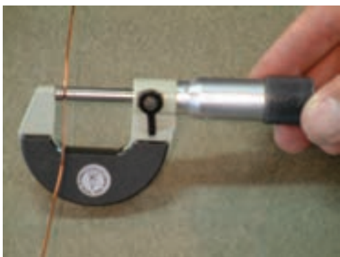
شکل ۱۶-۳-ب - اندازه‌گیری قطر سیم
