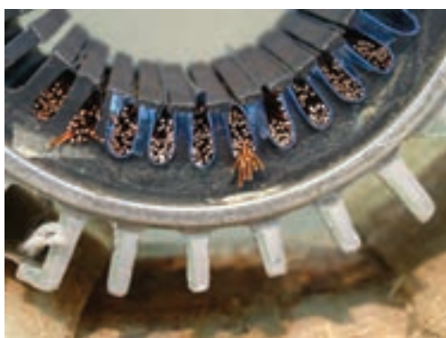
شکل ۲-۲۱- برش سیم‌ها در یک طرف استاتور
