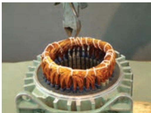
شکل ۲-۱۳ – چیدن نخ‌های کلاف بندی با سیم چین
