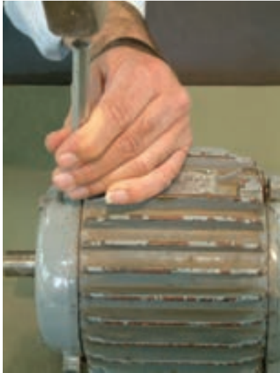
شکل ۱-۲۳- علامت‌گذاری روی پوسته و درپوش‌ها
