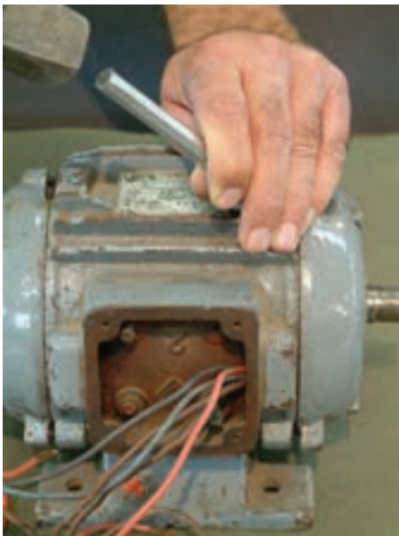
شکل ۱-۲۶- باز کردن درپوش موتور
