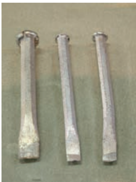
شکل ۲-۱۹- چند نمونه قلم برای بریدن سیم‌ها
