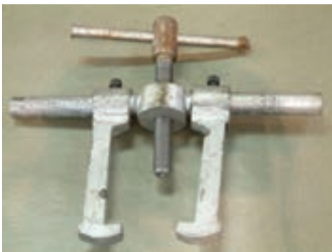
شکل ۱-۴۸- ابزار درآوردن بوش و یاتاقان‌های استوانه‌ای
