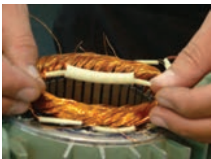
شکل ۱۰-۴- قرار گرفتن قسمت اتصال یافته (لحیم کاری شده) روی سیم ها
