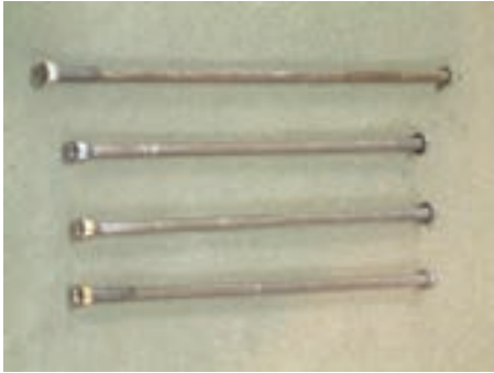
شکل ۱-۴۲ پیچ‌های بلند دو طرف رزوه شده
