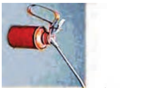
شکل ۱-۳۴- روغن کاری یاتاقان ها
