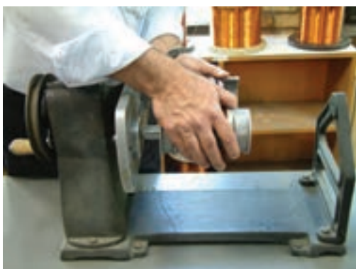
شکل ۱۸-۳- باز کردن قالب‌ها
