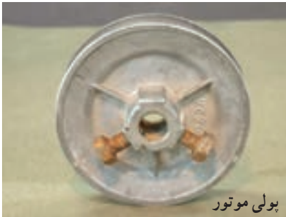
شکل ۱-۲۵- باز کردن پولی موتور
