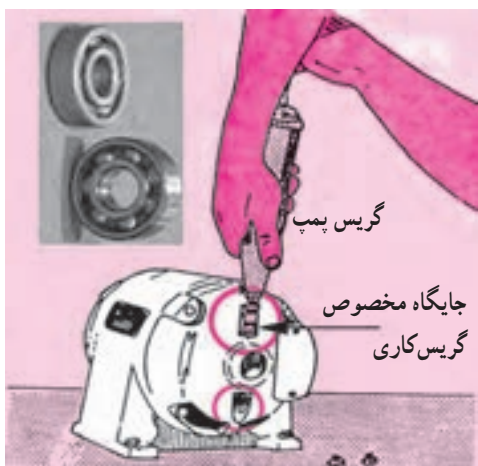
شکل ۱-۳۳ - گریس کاری بلبرینگ‌ها
