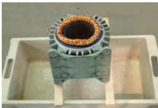
شکل ۴-۲۴- قرار دادن استاتور روی وان
