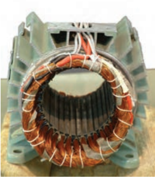
شکل ۴-۱۷– نمایش استاتور نخ‌بندی شده از دو سمت
