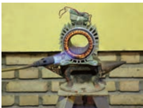
شکل ۲-۱۸- سوزاندن مستقیم سیم‌ها با شعله
