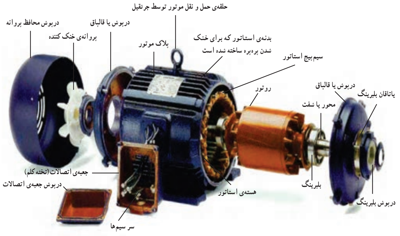
شکل ۱-۳- اجزای اصلی موتور سه فاز
