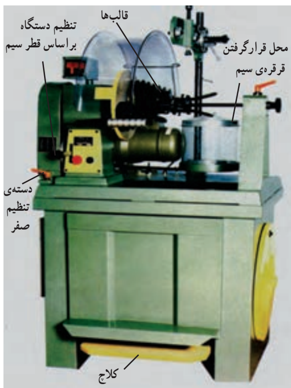
شکل ۳-۱۳- ماشین کلاف پیچ
