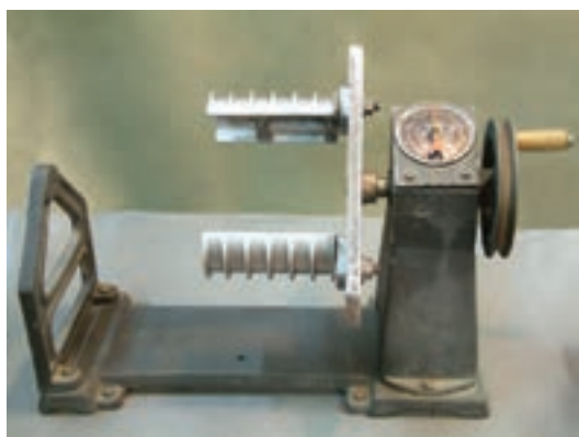
شکل ۳-۱۵- تنظیم اندازه‌ی قالب‌ها در کلاف پیچ
