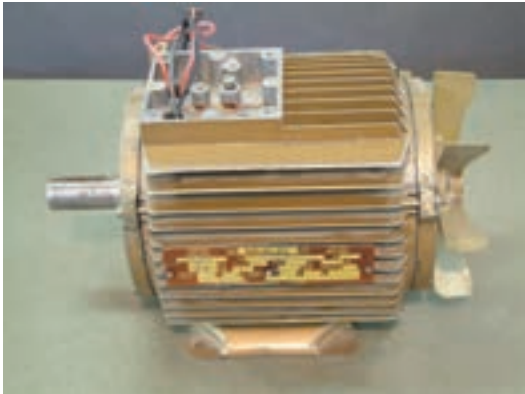
شکل ۱۹-۱- الکتروموتور سه فاز
