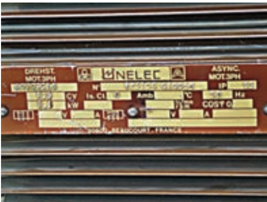
شکل ۲۰-۱- پلاک الکتروموتور سه فاز
